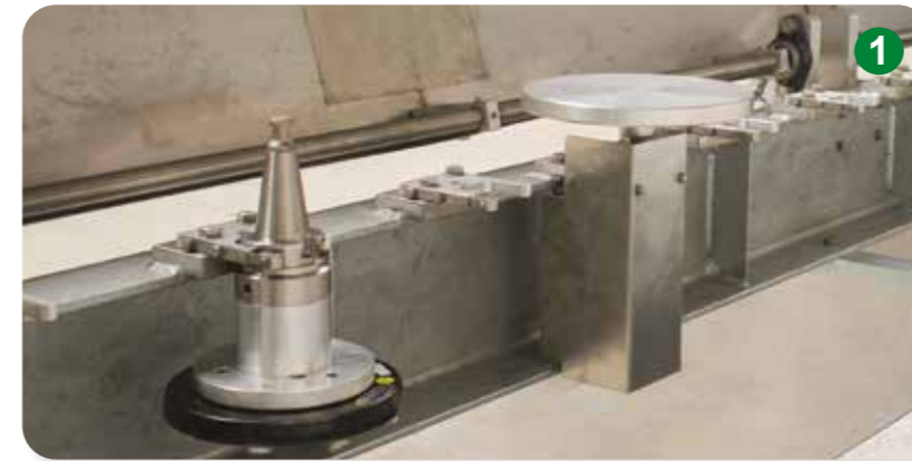
Electronic presetting for the automatic measuring of the length of the tools. Sonda presetting elettronica per il controllo della lunghezza utensile.
