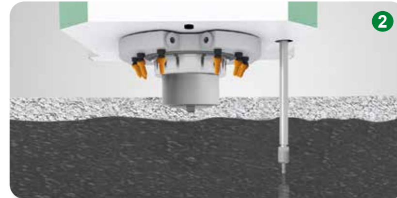
Electronic feeler for automatic measuring of the thickness of the slab. Sonda elettronica per la misurazione automatica dello spessore della lastra.
