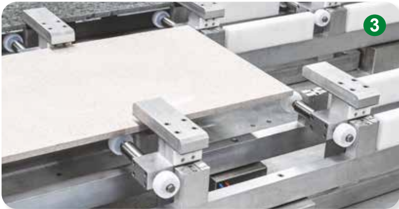
3 Система крепления обрабатываемых заготовок с пневматическими зажимами.
