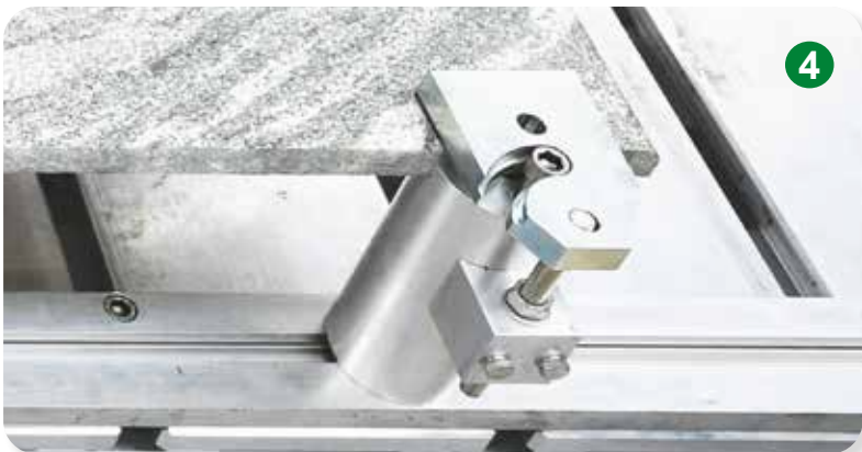
4 Направляющая с механическими зажимами для крепления обрабатываемых заготовок
